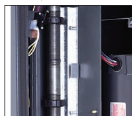
interruptores de límite accionamiento directo y fácilmente ajustable
